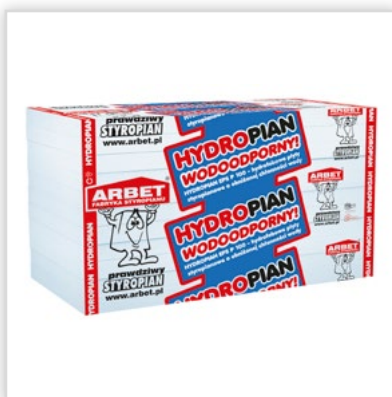
Płyty styropianowe Hydroplan EPS P 100. Zastosowanie: w miejscach szczególnie narażonych na silne, długotrwałe zawilgoconie i poddanych wyższym obciążeniom (dopuszczalne obciążenie użytkowe 3000 kg/m 2 ).
